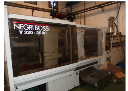
Inyectora termoplástico 320 ton.
