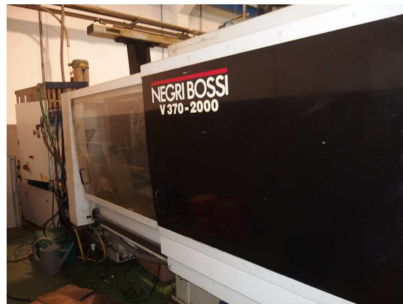
Inyectora termoplástico 370 ton.
