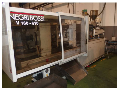
Inyectora termoplástico 160 ton.
