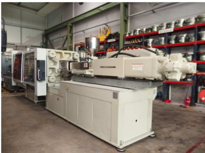
Inyectora termoplástico 480 ton.
