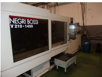
Inyectora termoplástico 210 ton.
