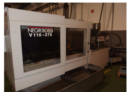
Inyectora termoplástico 110 ton.
